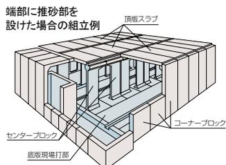
河川流域の都市化が進むにつれて、これまで流域が有していた保水遊水機能が低下し雨水流出量の増大をまねいています。「プレキャスト遊水池」はこの雨水流出抑制施設(雨水貯留施設、雨水貯留浸透施設)を地下に設け、地上を公園、運動場、駐車場等多目的に利用できる、プレキャスト遊水池です。
