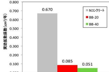
クロロガードを配合することにより、塩化物イオンの実効拡散係数は小さくなります。
