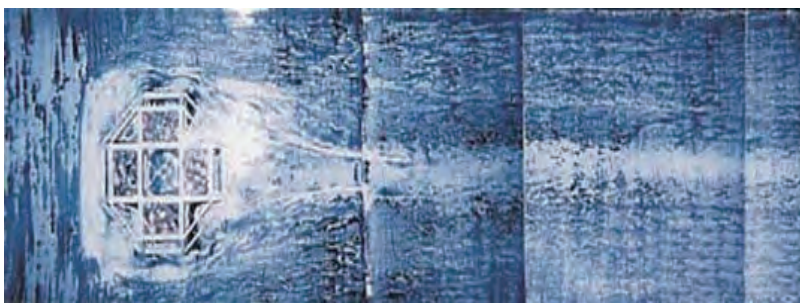
油膜法による実験（平面）
