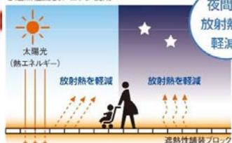
太陽光を反射し、舗装材の表面温度が温まりにくくなります。また、蓄熱しにくいので夜間の放射熱を軽減します。
