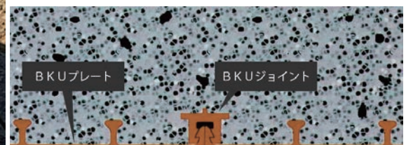
●BKUプレートとコンクリートの固着断面 (CG)
